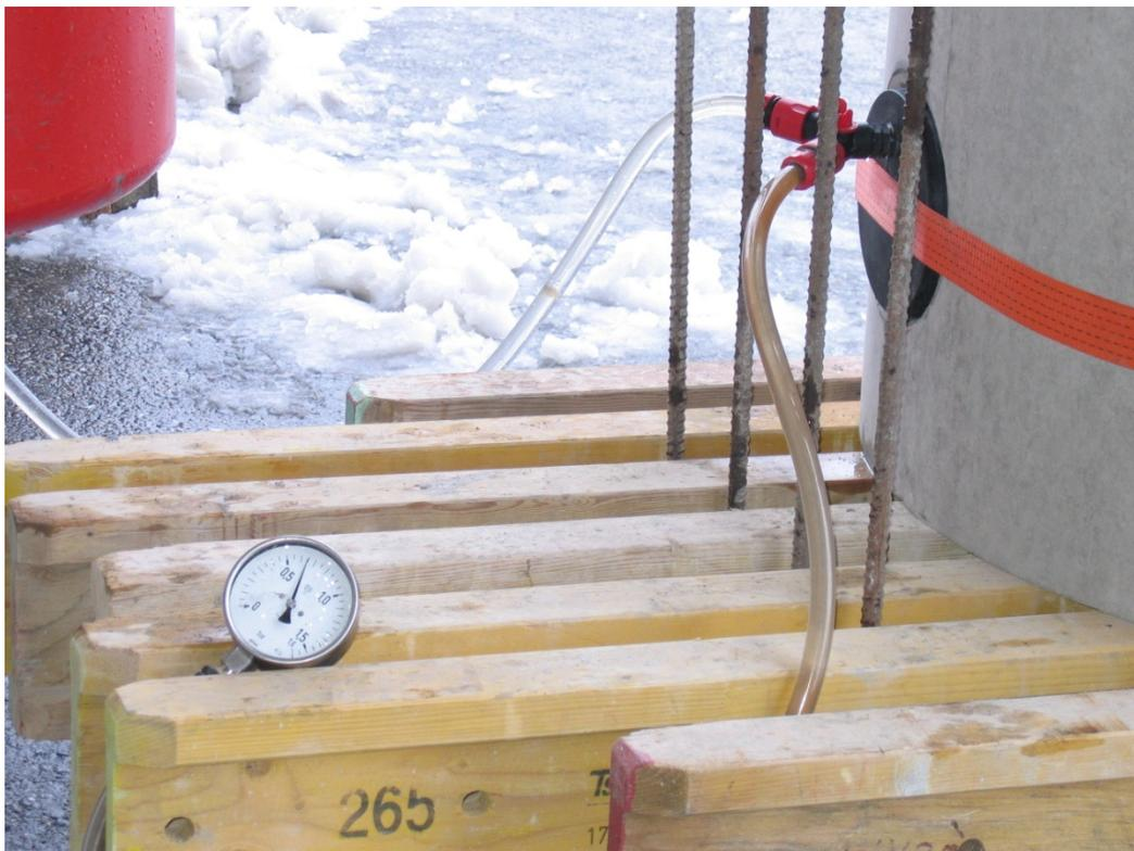
Abb. 3 2. Versuch: Prüfung des Schachtbodens DN1000/1000 in Schüpbach am 01. Dezember 2009. Der Druck von 0.55 bar konnte 20 Minuten lang gehalten werden. Es sind keine Wasseraustritte beim Ein/Auslass sichtbar.
