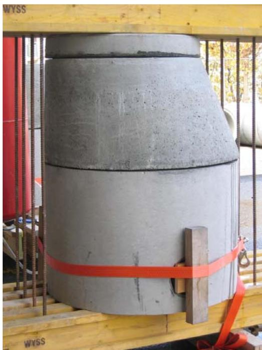
Abb. 2 Prüfung des Schachtbodens DN 600/600 in Schüpbach am 15. Oktober 2009. Der Druck von 0.55 bar konnte 20 Minuten lang gehalten werden. Es sind keine Wasseraustritte beim Ein/Auslass sichtbar.
