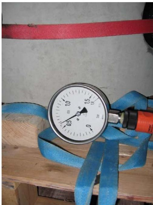
Abb. 1 Prüfung des Schachtbodens DN 600/600 in Burgdorf am 15. Oktober 2009. Der Druck von 0.55 bar konnte 20 Minuten lang gehalten werden. Es sind keine Wasseraustritte beim Ein/Auslass sichtbar.
