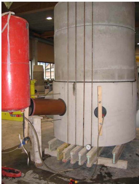
Abb. 3: Prüfung des Schachtbodens DN 800/800 mit zwei Schachtringen 1000 mm und 500 mm
