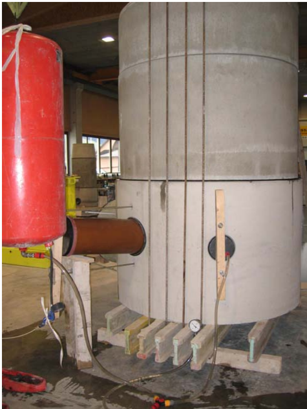
Abb. 6: Prüfung des Schachtbodens DN1500/1500 mit zwei Schachtringen 1000 mm und 500 mm
