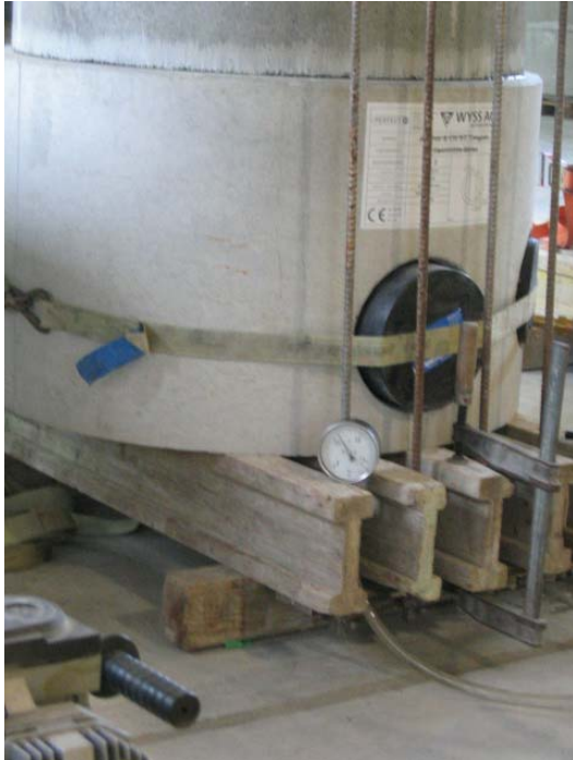
Abb. 1: Prüfung des Schachtbodens DN 600/600 mit Schachtring 500 mm
