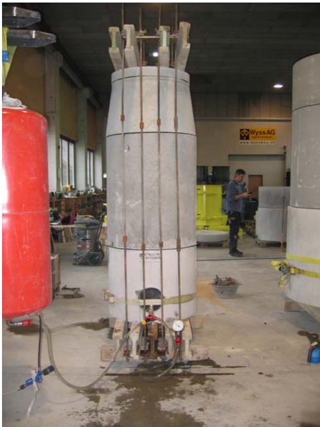
Abb. 2: Prüfung des Schachtbodens DN 700/700 mit Schachtring 1000 mm und Konus 500 mm
