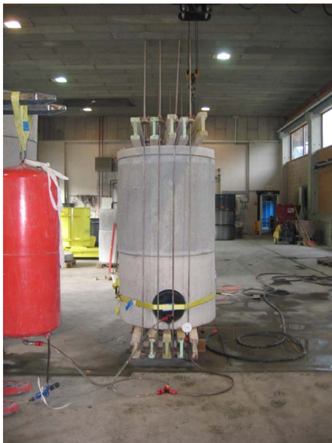
Abb. 4: Prüfung des Schachtbodens DN 900/1100 mit Schachtring 1000 mm
