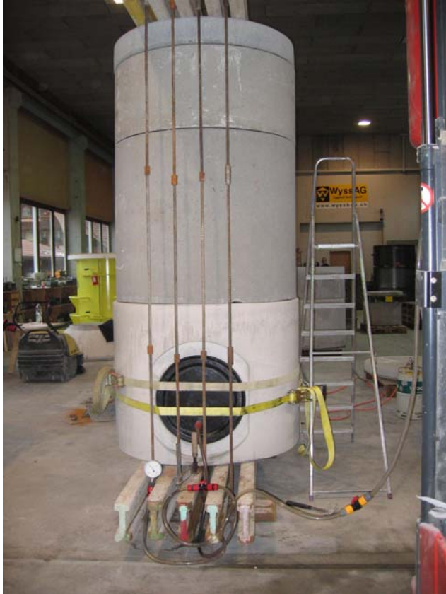
Abb. 5: Prüfung des Schachtbodens DN 1000/1000 mit zwei Schachtringen 1000 mm und 500 mm
